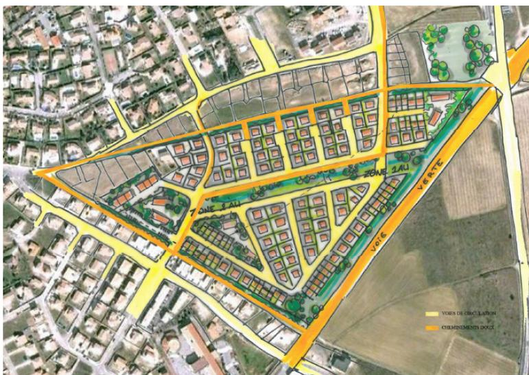
**Illustration de l'orientation d'aménagement** (les tracés des voies peuvent être adaptés, les grands principes de connexions viaires précisés dans le texte ci-contre devant être respectés)
